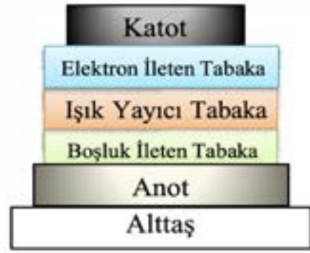
Şekil 3: Temel OLED yapısı.
