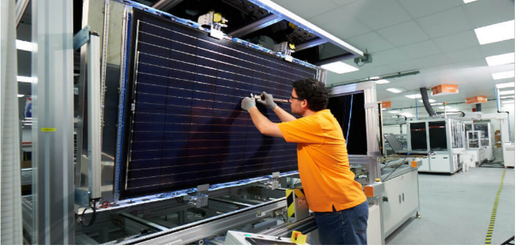
Şekil 3.9. Panel görsel kontrol
