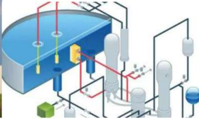
ABD Vogtle Westinghouse AP1000 büyük nükleer reaktörleri ve havuzlu pasif güvenlik sistemi
