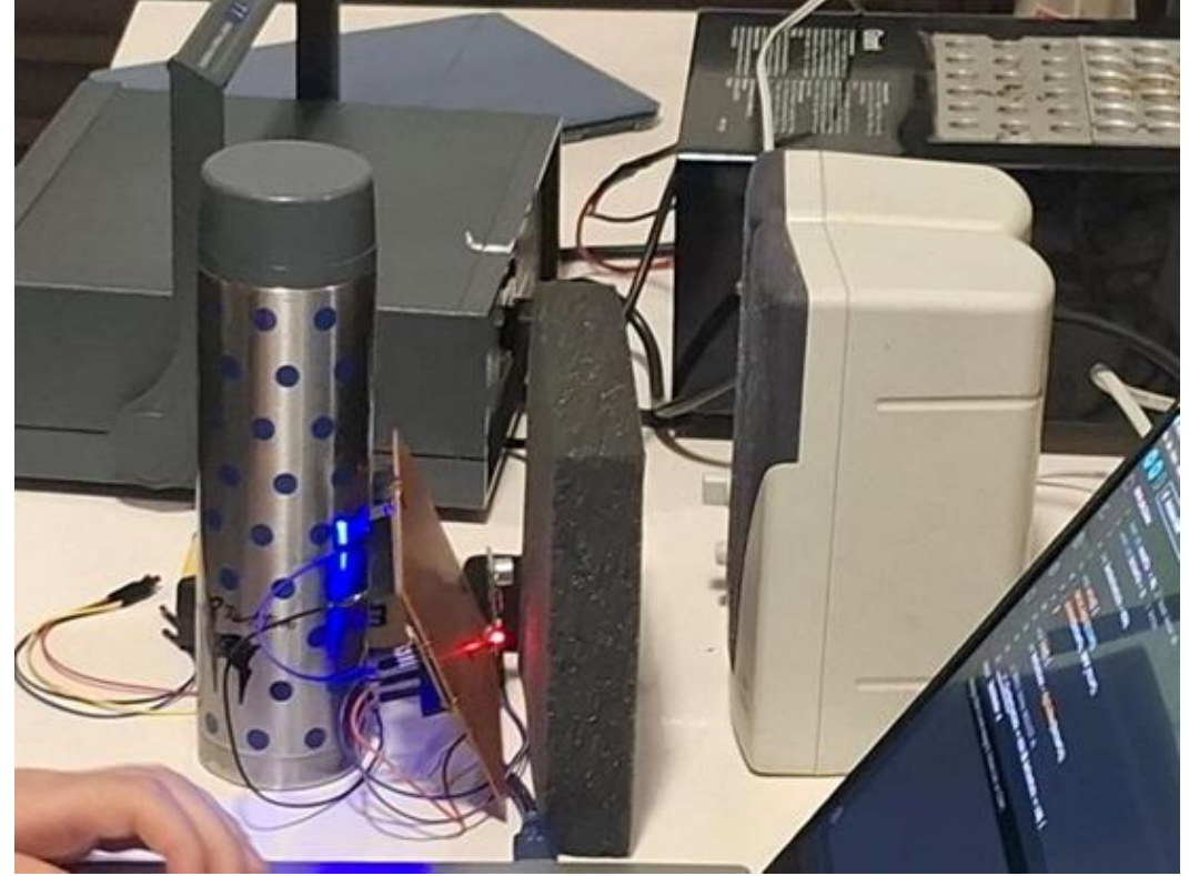
Görsel-3 Sensör ve gürültü ölçerin konumlandırılması
